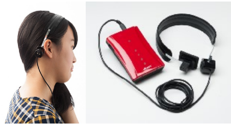
図 1 骨導超音波知覚を利用した重度難聴者のための新型補聴器 (Nakagawa et al. 2015)。
