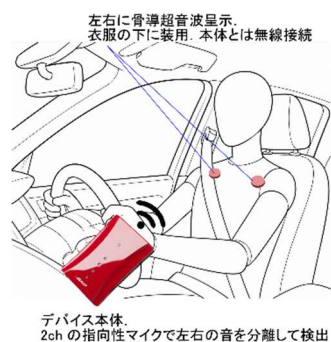
図 8 自動車運転時の重度難聴者の音像定位を可能にする 2ch 遠位呈示骨導超音波デバイス
