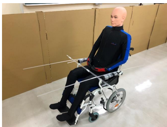
図 5 自動運転車いすを模擬した装置(プラスチック棒はセンサの感知範囲を模擬したもの)
