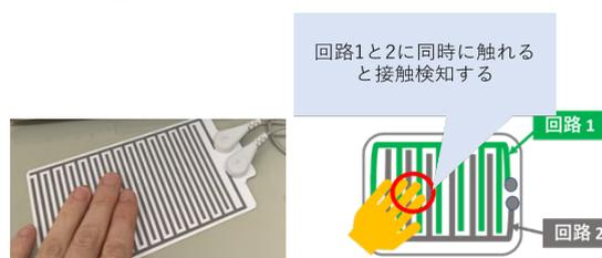
図1 生体電極を利用したセンサシートの仕組み
