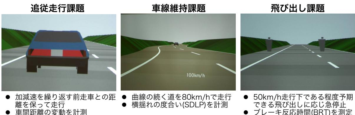
図 2 研究用ドライビング・シミュレータ(豊田中央研究所製)の課題概要
