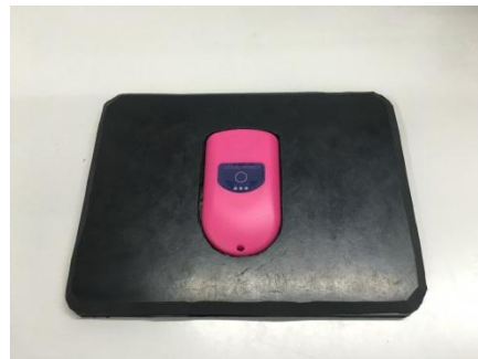
図2 回転加速度測定用マット
