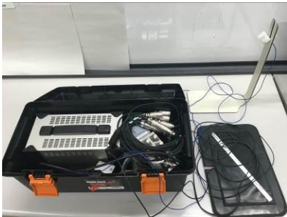
図 4 加速度および騒音測定システム
