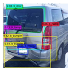
損傷部位判定画面のイメージ
