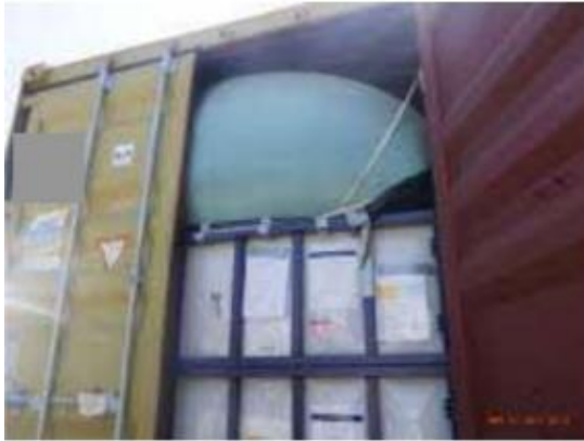
貨物が輸送中に発酵し膨張したタンクとその圧力により壁が歪んだコンテナ（出典：IUMI）
