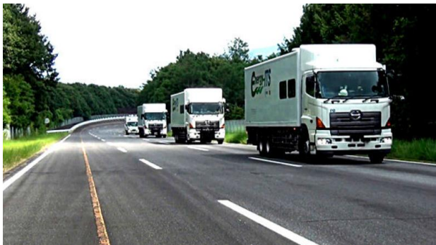
写真①：大型トラックの自動隊列走行の様子
