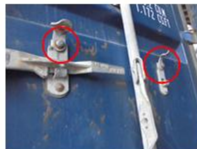
<取り替えられたボルト>
