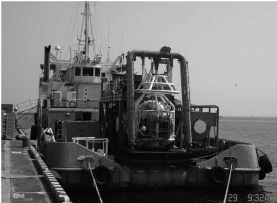
写真：飽和潜水システム搭載船（出典：深田サルベージ建設株式会社ご提供）
