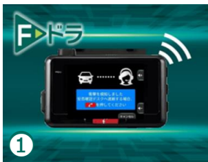
① 衝撃を検知すると専用ドライブレコーダーが反応し、三井住友海上に映像や走行データを送信。
