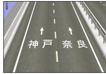
図4 採用する路面標示
